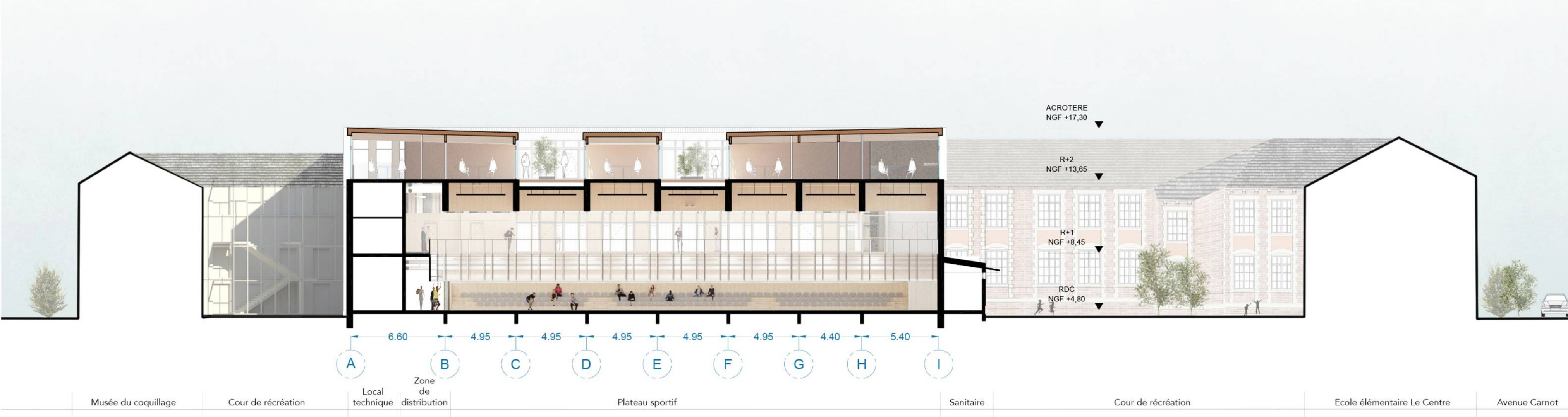
COUPE BB' - 1/200e - Des toitures en pente vers les patios centraux du R+2, accueillent des panneaux solaires de manière invisible depuis l'espace public.
