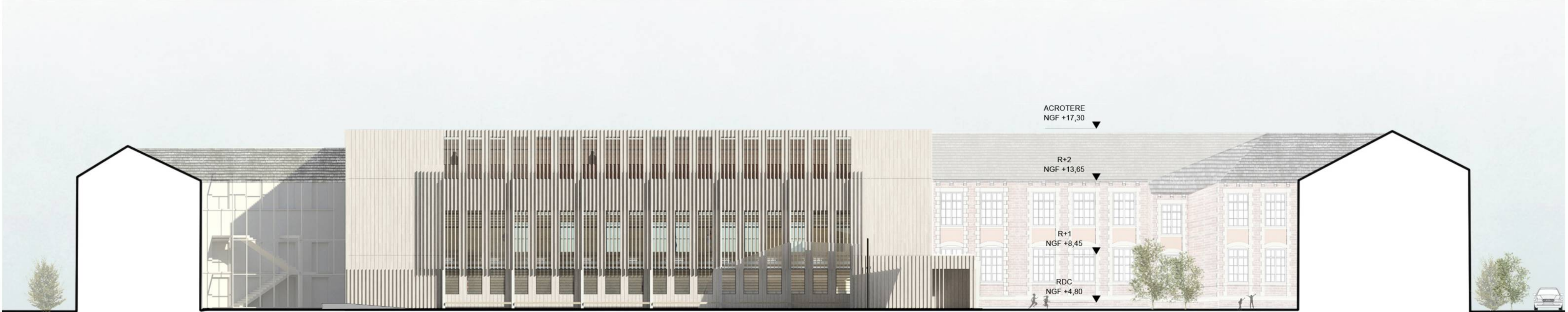
FACADE SUD- 1/200e - Protection solaire, résistante et pérenne par le rythme d'une façade minérale formant brise-soleil dans la cour du collège au sud.
